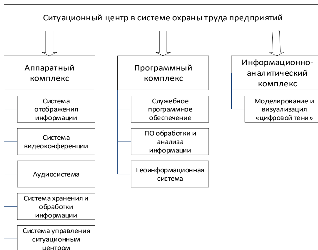
Рис. 2. Структурная схема ситуационного центра в системе охраны труда предприятий
