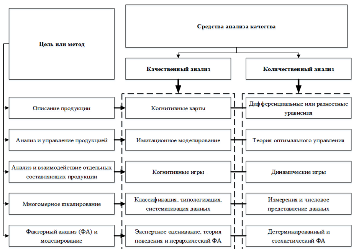
Рис. 4. Классификация подходов к оценке качества программного обеспечения [4]
