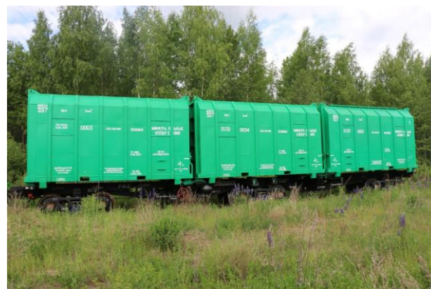
Рис. 4. Сменный кузов железнодорожного грузового вагона для перевозки минеральных удобрений
