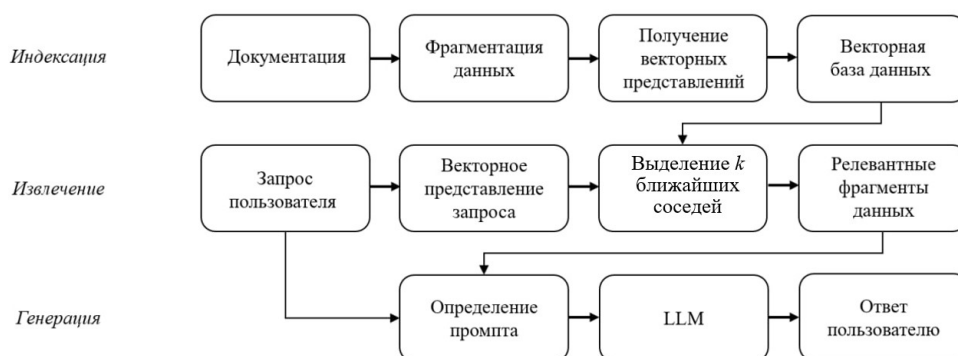
Рис. 1. Общая архитектура классической векторной технологии RAG
