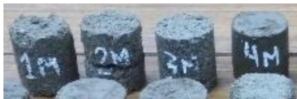
Рис. 1. Образцы глины, извлеченные из бурта для определения плотности и влажности, шаг извлечения – 1 м
