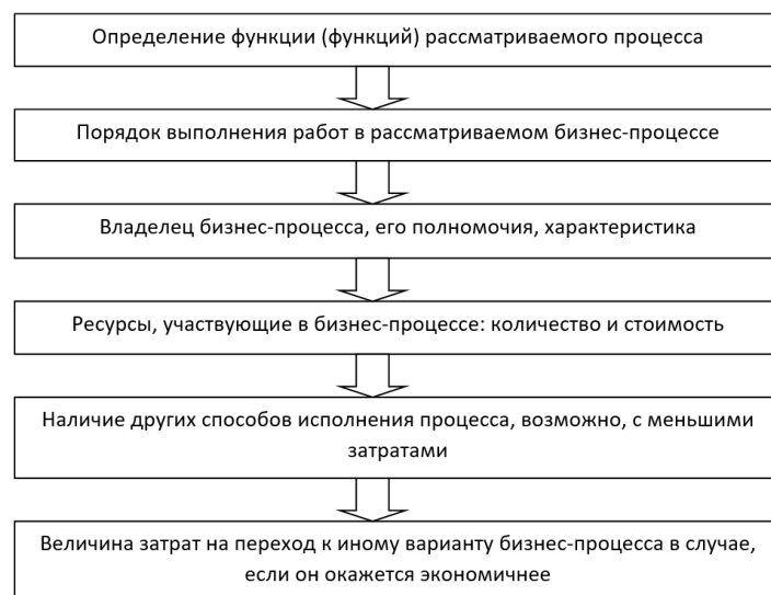
Рис. 3. Последовательность реализации метода функционально-стоимостного анализа
