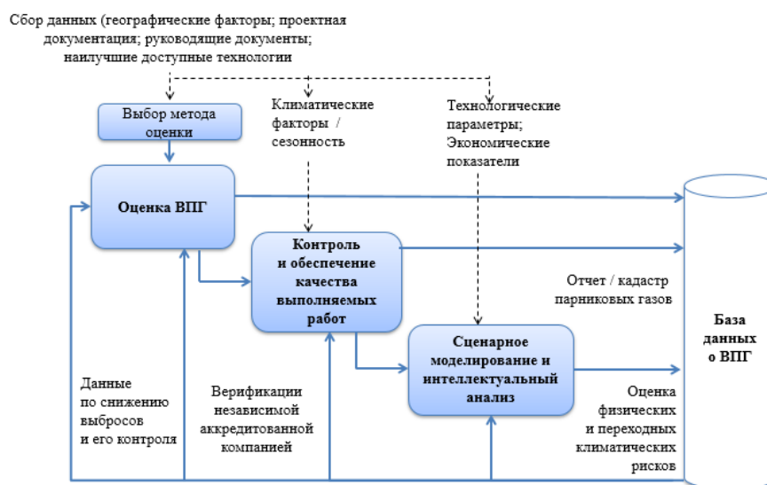
Рис. 3. Блок-схема логико-информационной модели инвентаризации выбросов парниковых газов
